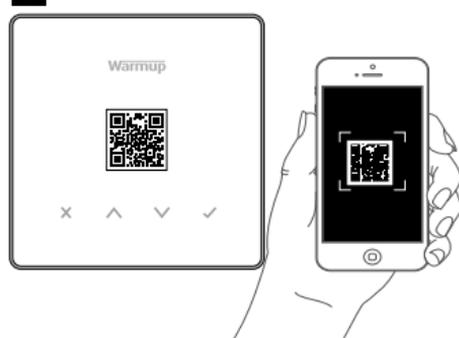
Öffnen Sie die My Heating App und scannen Sie den QR-Code auf dem Bildschirmschutz des Thermostats oder auf der Rückseite des Displays. Folgen Sie den Anweisungen in der App, um die Einrichtung abzuschließen.
