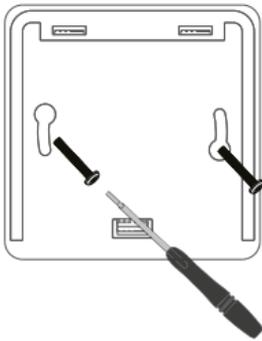
Führen Sie die Befestigungsschrauben durch die Befestigungslöcher der Wandhalterung und ziehen Sie diese fest.
