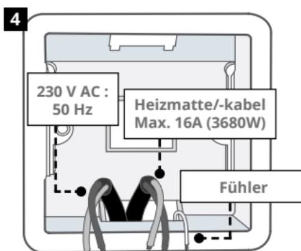
Installieren Sie eine 50 mm tiefe Unterputzdose/Hohlwanddose am bevorzugten Thermostatstandort. Ziehen Sie die Kabel (Heizmatte/ Kabel/Netzspannung und Sensor(en)) durch die Dose und vervollständigen Sie die Anschlussverkabelung.
