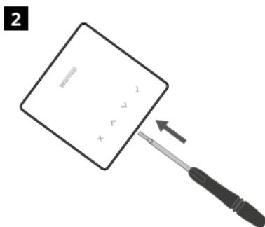
Lösen Sie das Display von der Wandhalterung des Thermostaten.
